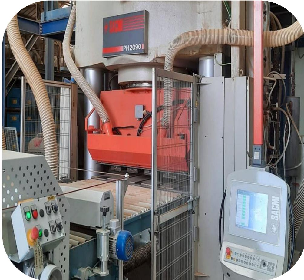
*Donne la forme de carreau à la poudre suivant des spécifications exactes en ce qui concerne les dimensions, la compacité, la densité, et le degré d'humidité*
