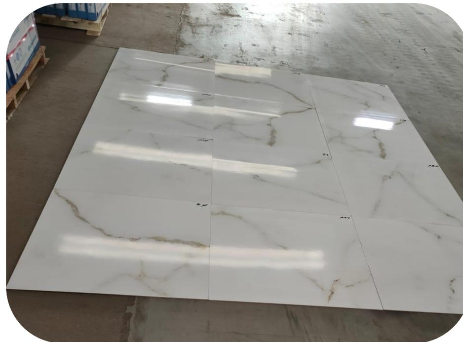
*Exigence : 95% au moins des carreaux doivent des carreaux doivent être exempts de défauts visibles susceptibles de nuire à l'aspect d'une zone importante du carrelage*
